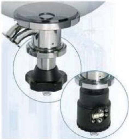
La vanne de fond de cuve type VFA est la solution idéale pour maintenir les conditions de stérilité en cours de process et lors des phases de NEP/SEP. Elle offre à la tuyauterie aval un passage propre et totalement drainable. La membrane est parfaitement affleurante à la cuve, empêchant les bras morts. La vanne de fond de cuve VFA est conforme aux réglementations de la FDA, aux normes sanitaires 3A et est fabriqué conformément au cGMP.
