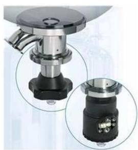
La vanne de fond de cuve type VFA est la solution idéale pour maintenir les conditions de stérilité en cours de process et lors des phases de NEP/SEP. En aval de la tuyauterie, elle offre un passage propre et totalement drainable. La membrane est parfaitement affleurant à la cuve, empêchant les bras morts. La vanne de fond de cuve VFA est conforme aux réglementations de la FDA, aux normes sanitaires et est fabriqua conformément au cGMP.
